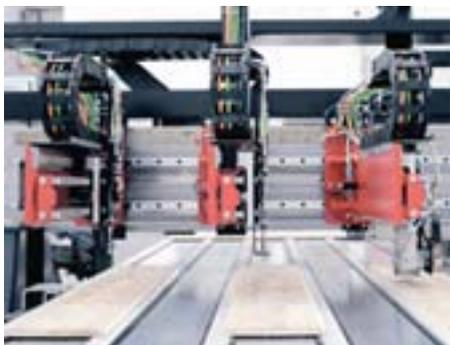
Die Ausbesserungsanlage „speedfiller“.
